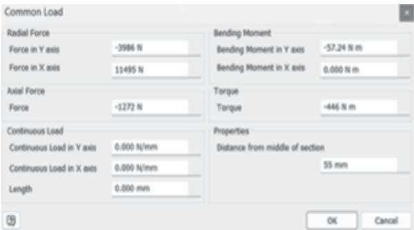
d) Nhập các giá trị lực tác dụng và mô men tại vị trí bánh răng côn.
